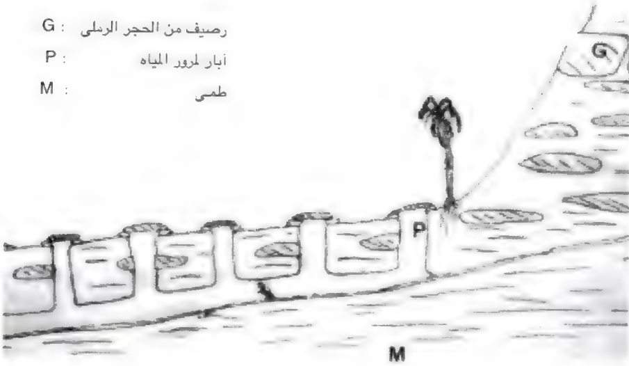
٧- رسم تخطيطي لحفر قناة بفتحات تسمح بنزول مجار مائية لتغذيتها.
